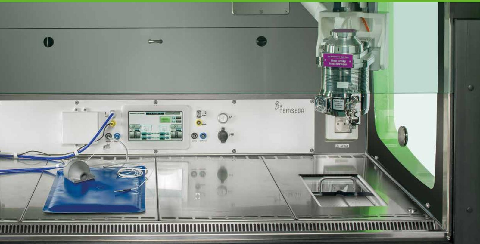
Vollständig integriertes Anästhesiesystem für ARIA Sicherheitswerkbänke der Klasse II und Käfigwechselstationen, die speziell für Tierversuchslabors entwickelt wurden, Tecniplast ARIA TECH 48 & 60 GAS, mit einem vollständig integrierten TEM SEGA Anästhesiesystem, gewährleisten eine effektive mikrobiologische Sicherheit bei chirurgischen Eingriffen an Tieren Tieroperationen oder -experimenten und verhindert Kreuzkontaminationen und Allergenexposition.
